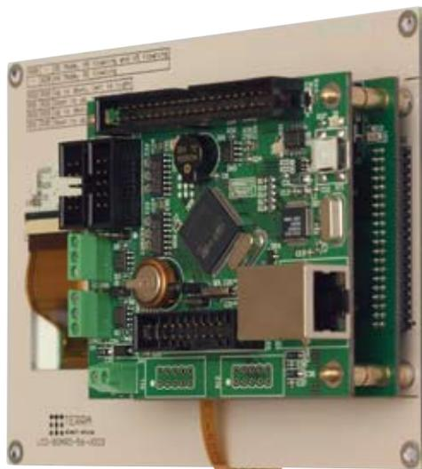
Рис. 4. Микроконтроллерная система на основе TE-ULCD56 и TE-STM32F107
