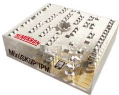
Рис. 1. Модуль IPM MiniSKiiP® с пружинными контактами и интегральным драйвером
