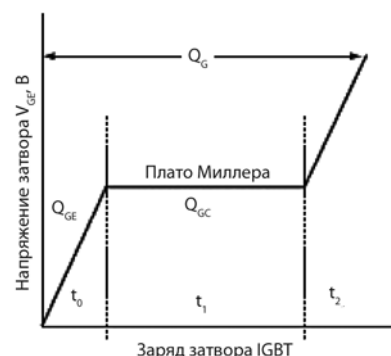
Рис. 2. Типичная зависимость заряда затвора IGBT от V_{GE} определяет среднеэффективное значение эффективной емкости затвора
