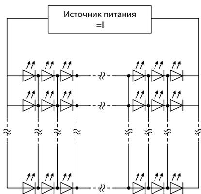
Рис. 2. Матричная схема включения светодиодов
