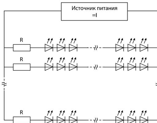
Рис. 3. Схема включения цепочек светодиодов с балластным резистором
