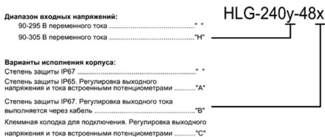
Рис. 5. Схема выбора опций источников питания HLG-240
