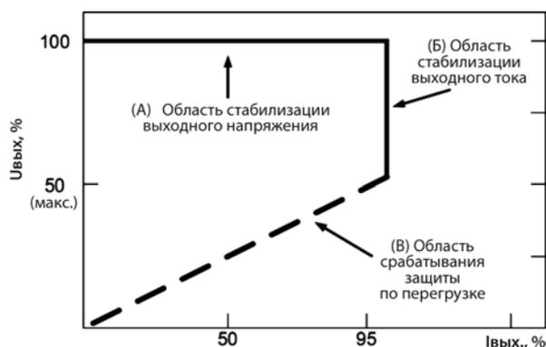
Рис. 2. Вольт-амперная характеристика источника питания серии CEN-100
