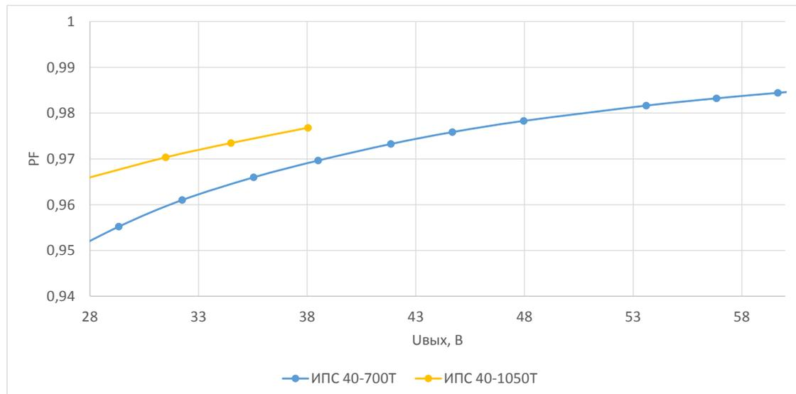
Все параметры измерены при напряжении питания 220В AC и номинальной нагрузке при 25° C окружающей среды.
