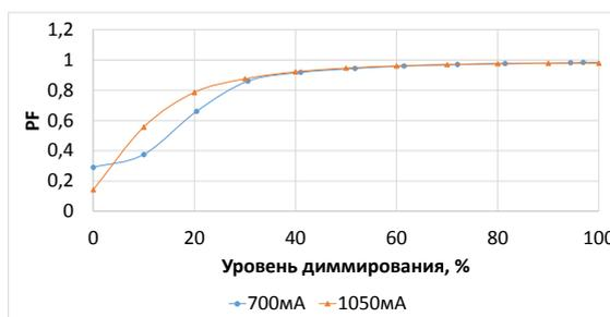
Все параметры измерены при напряжении питания 220В AC и номинальной нагрузке при 25° С окружающей среды.
