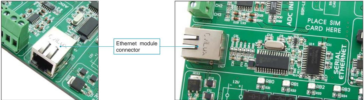
Figure 8-1: Ethernet module
