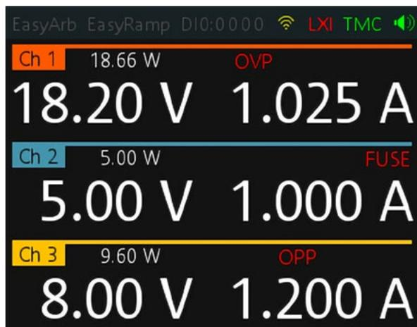
Выполняемые функции защиты всегда отображаются на экране
