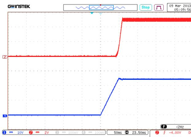
Рис. 21. Установление  $U_{\text{ВЫХ.НОМ}}$  с момента подачи  $U_{\text{ВХ.НОМ}}$ .
