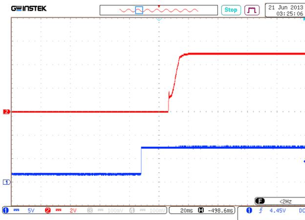
Рис. 24. Установление  $U_{\text{вых.ном}}$  с момента подачи ДУ (управляющий сигнал).
