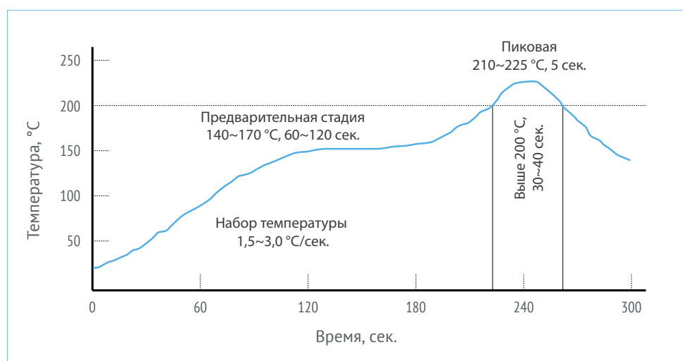
Рис. 26. График и рекомендации по настройке термопрофиля в печи конвекционного нагрева.
