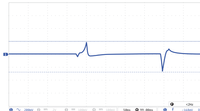
Рис. 7 (г). Осциллограмма переходного отклонения выходного напряжения при изменении выходного тока.
